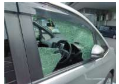
飛石により窓ガラス破損
